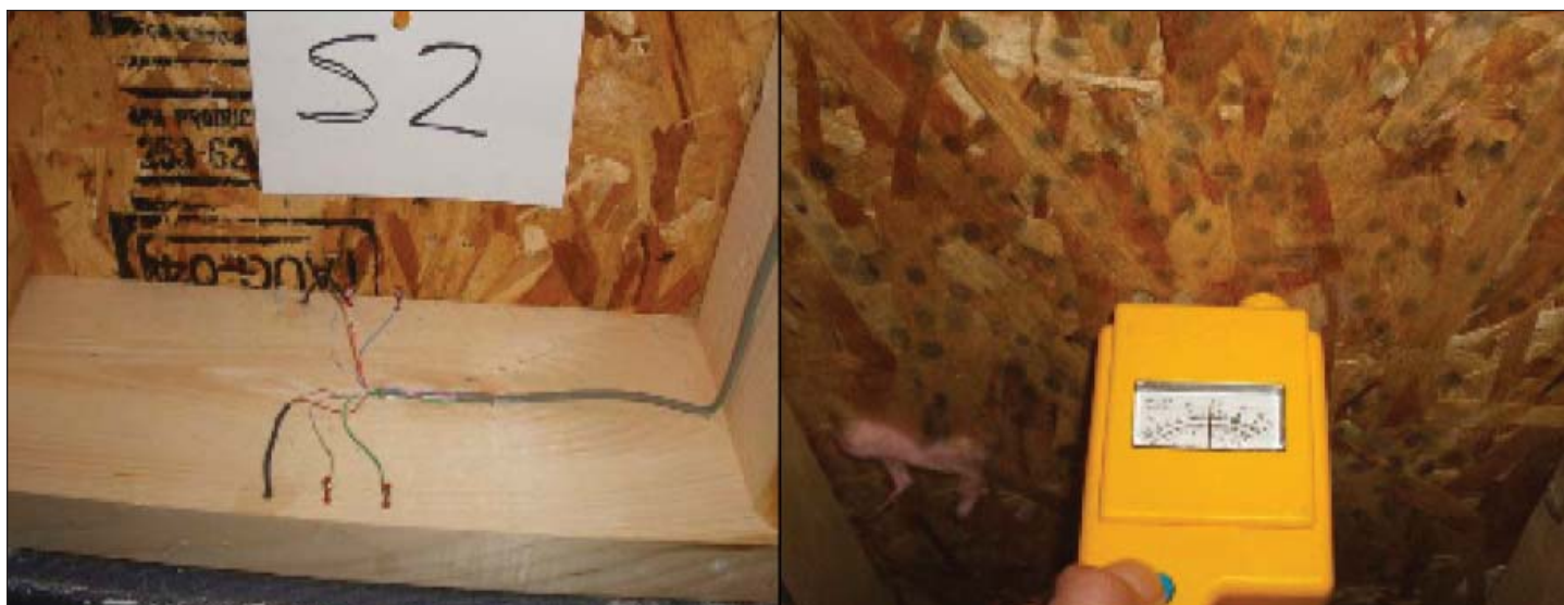
Figure 1 Mur sans polyéthylène exposé au sud dépourvu de taches (à gauche) et cellules de moisissures sur un mur sans polyéthylène exposé au nord
